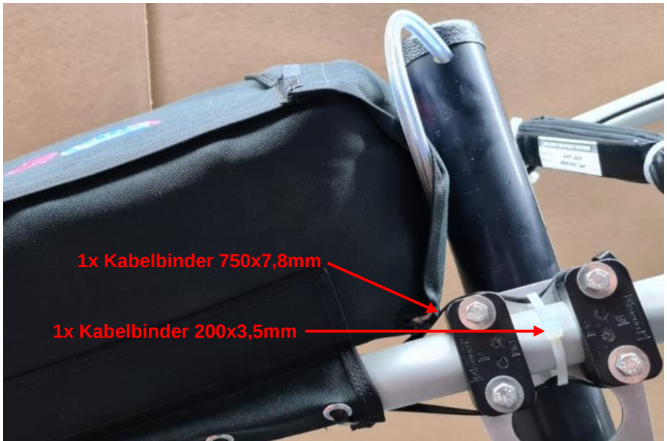
Abbildung 13: Befestigungspunkte Kabelbinder BRS-6-1050-SP
