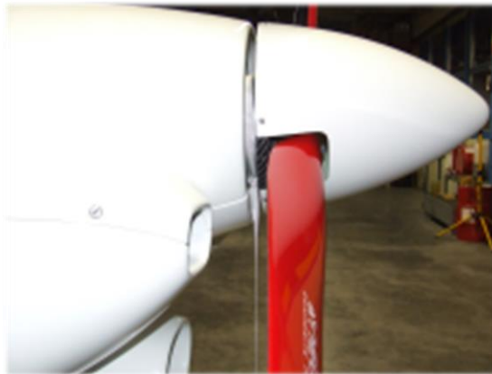
Abbildung 6: Befestigungspunkt zwischen Cowling und Propellerspinner
