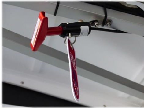
Abbildung 8: Auslösegriff mit Sicherheitspin
