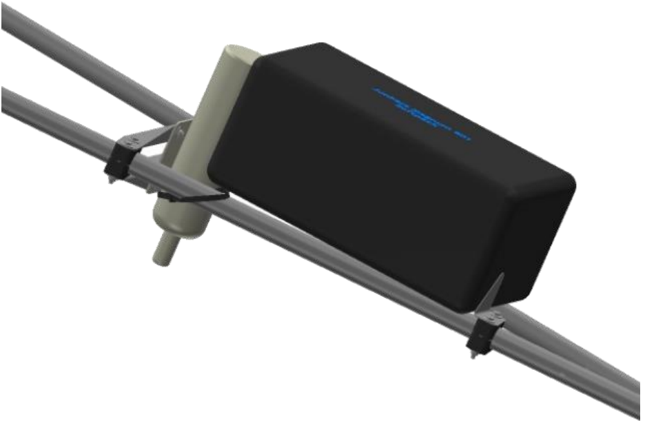
Abbildung 20: Einbauposition Fangwinkel Junkers Magnum 601
