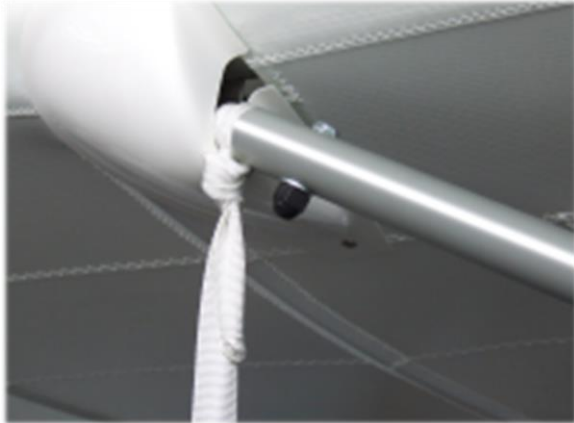
Abbildung 5: oberer Befestigungspunkt an vorderer Flächenstrebe
